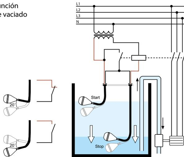
Conectando el hilo negro y el marrón, el circuito cierra cuando el flotador está arriba y abre cuando el flotador está abajo.
