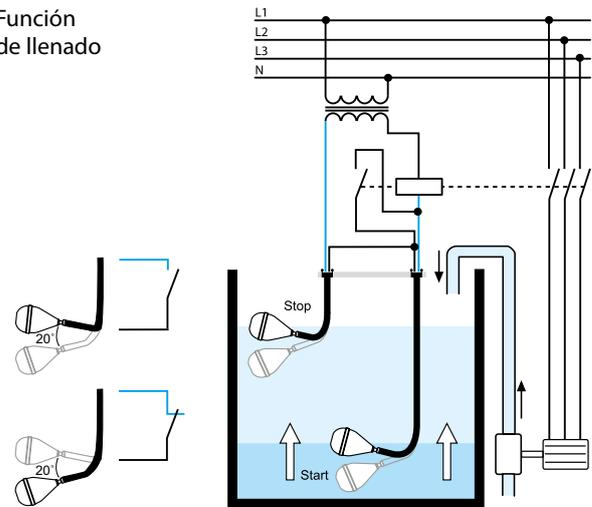
Conectando el hilo negro y el azul/gris, el circuito abre cuando el flotador está arriba y cierra cuando el flotador está abajo.
