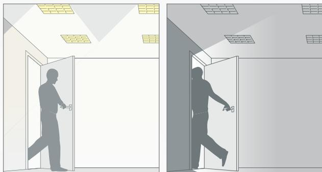
**Detección de presencia:** Los detectores encenderán la iluminación automáticamente cuando una persona entre en la habitación y la apagarán automáticamente cuando ya no se detecte movimiento.
