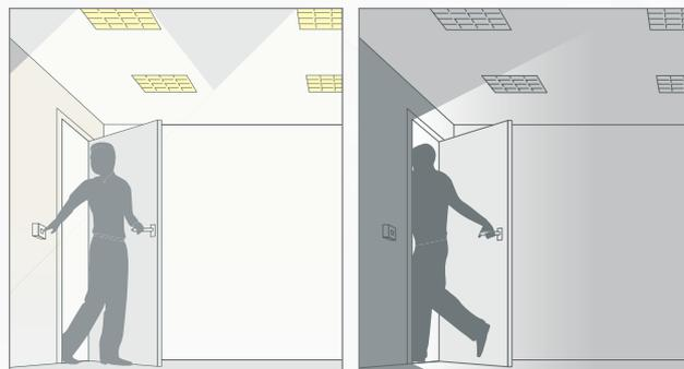
**Detección de ausencia:** Al entrar en una habitación, la persona enciende la iluminación mediante el interruptor, pero al salir el detector apaga la iluminación automáticamente. Las luces también se pueden apagar manualmente.
