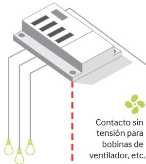
Contacto sin tensión para bobinas de ventilador, etc.
