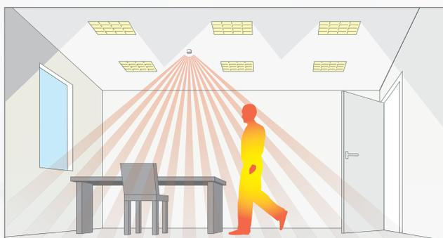
**Detección PIR (Infrarrojo pasivo):** Los detectores PIR funcionan detectando el movimiento del calor corporal. Son más adecuados para espacios pequeños o donde se requiera un patrón de detección concreto.
