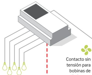
Contacto sin tensión para bobinas de ventilador, etc.
