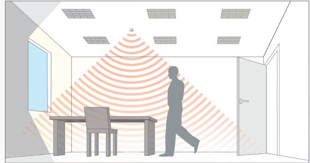
Se detecta presencia, suficiente luz natural, luces apagadas.
