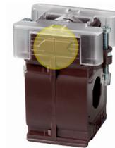
**2** Los terminales secundarios, según el modelo, pueden fijarse con tuercas, tornillos, doble lengüeta + tornillo; este último es útil para cortocircuitar el secundario del TI antes de desconectar los equipos y evitar así que se generen tensiones peligrosas con la apertura del circuito (funcionamiento sin carga).
