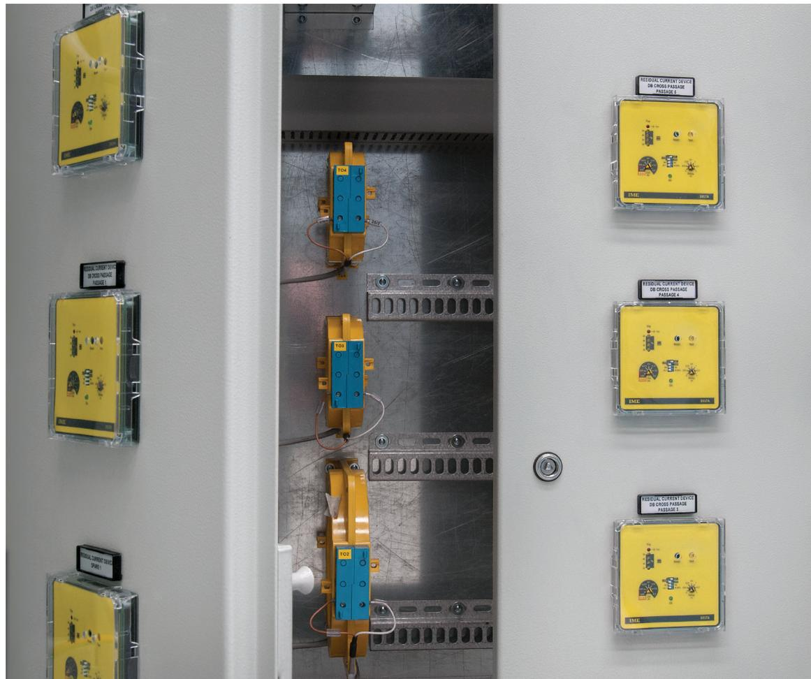
Una característica importante de la serie Delta es el control permanente del circuito de conexión entre el relé diferencial (ELR) y el transformador de corriente TI toroidal: mediante la detección de cualquier anomalía en la conexión entre el TI toroidal y el ELR, la protección interviene de forma automática, sin esperar a la revisión periódica realizada accionando el pulsador de test.
