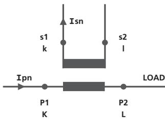
**1** Algunos modelos cuentan también con flechas que indican la forma correcta de realizar la conexión al TI en el cable/la barra para evitar errores de inversión de corriente.
