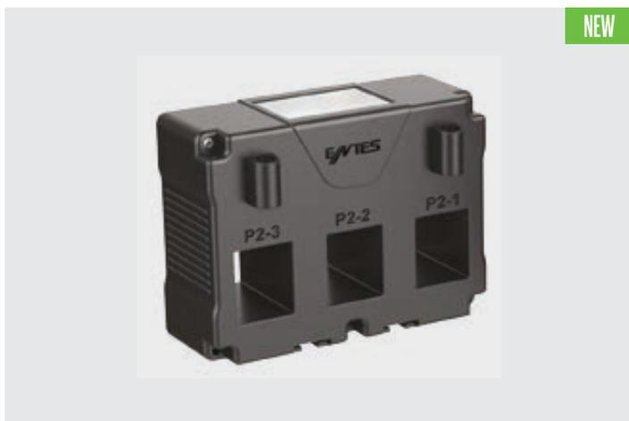
La serie de transformadores de corriente ENS.3PMD 25/30/50 proporcionan datos de la corriente de las tres fases a los nuevos dispositivos tipo Plug & Meter desarrollados por ENTES a través de un simple cable RJ45. Diseñado de acuerdo con los estándares de los interruptores magnetotérmicos, la serie de transformadores ENS.3PMD trabajan en una rango de hasta 1600A con 3 tamaños diferentes.
