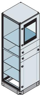
Estructura montada serie IS2 dim. 2000 x 610 x 610 mm (2105 x 610 x 610 mm. HxAxP exteriores) IP65 versión ordenador con puerta transparente para monitor, mesa para teclado, módulo para CPU, paneles laterales y zócalo H = 100 mm (tapas incluidas).
