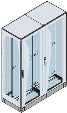
Dos estructuras montadas serie IS2 dim. 2000 x 600 x 600 mm (2105 x 1204 x 610 mm. HxAxP exteriores) IP65 con puerta ciega, placa de montaje, paneles laterales, tapas entrada cables correderas, kit de unión estructuras/placas y zócalo H = 100 mm (tapas incluídas).
