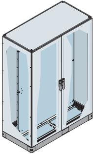
Estructura montada serie IS2 dim. 2000 x 1200 x 600 mm (2105 x 1210 x 610 mm. HxAxP exteriores) IP65 con puerta ciega, placa de montaje, paneles laterales, tapas entrada cables correderas y zócalo H = 100 mm (tapas incluidas).
