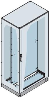
Estructura montada serie IS2 dim. 2000 x 1.000 x 600 mm (2105 x 1010 x 610 mm. HxAxP exteriores) IP65 con puerta ciega, placa de montaje, paneles laterales, tapas entrada cables y zócalo H = 100 mm (tapas incluídas).
