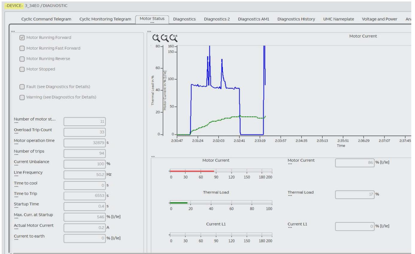
Con este software y la pantalla UM100 PAN podremos conectarnos al UMC directamente por medio de un cable USB.
