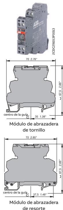
Relé: 1 contacto de bajo nivel DPDT, 1 mA hasta 8 A - paso de 12 mm 0,472"
