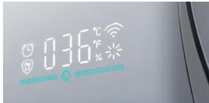
Un sensor de precisión de alta definición instalado en la rejilla de aspiración detecta la presencia de polvo y alérgenos en el aire y muestra la información en la pantalla en tiempo real. Cuando la calidad del aire es buena, se enciende la luz verde. Cuando es deficiente, se enciende la luz roja de alarma.
