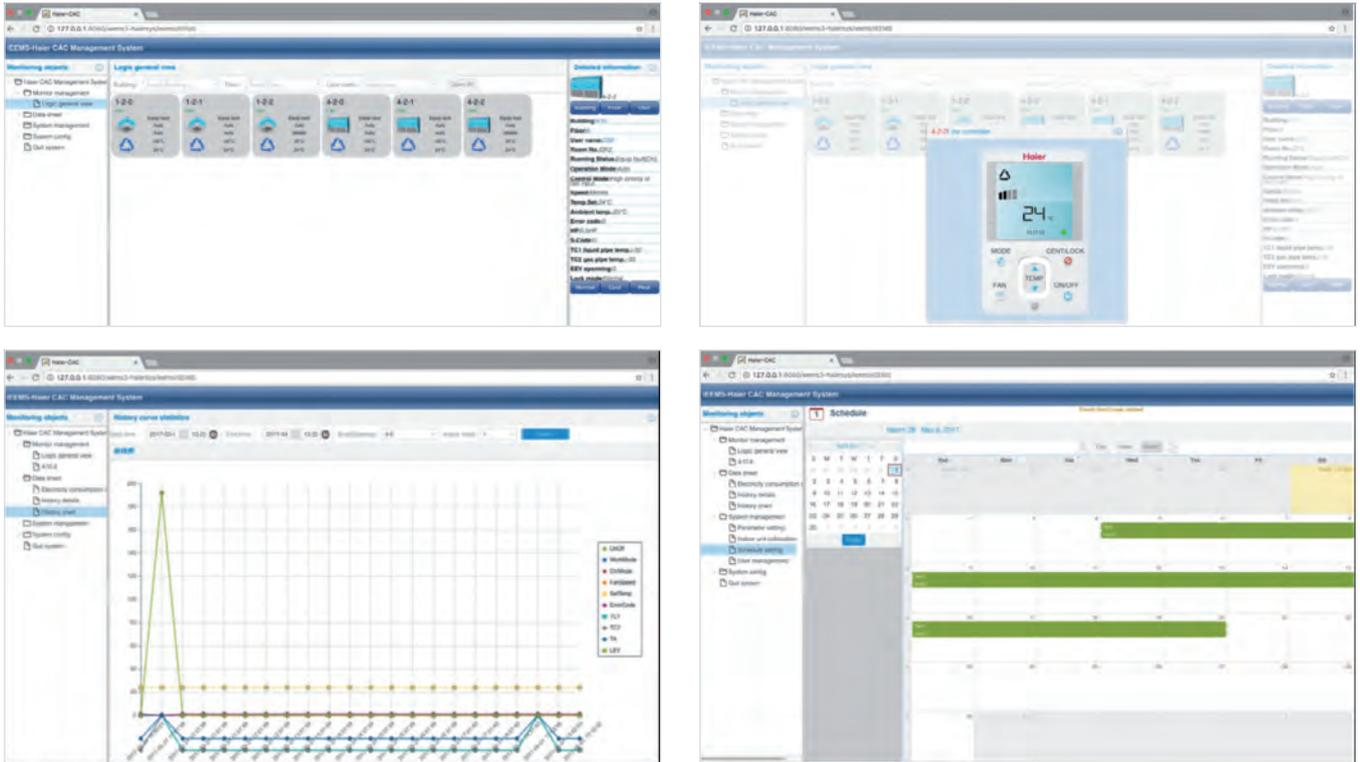
Posibilidad de insertar el diseño del edificio como un archivo en el sistema HCM-03A para configurar mediante la colocación de la unidad interior específica y comandos específicos. La creación de botones de comando específicos dentro de las instalaciones permite la gestión directamente en el plano, simulando más la realidad lo que hace todo más intuitivo y simple.
