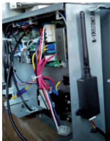
Adaptador de radio para la unidad interior que se conectará a la placa electrónica correspondiente.
