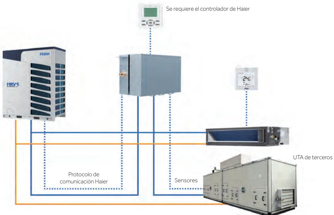
Tuberías de refrigerante líquido/gas, solo la tubería de líquido entra en la caja de válvulas y luego continúa a la batería de expansión directa. La tubería de gas va directamente de la unidad exterior a la batería dentro del UTA.
