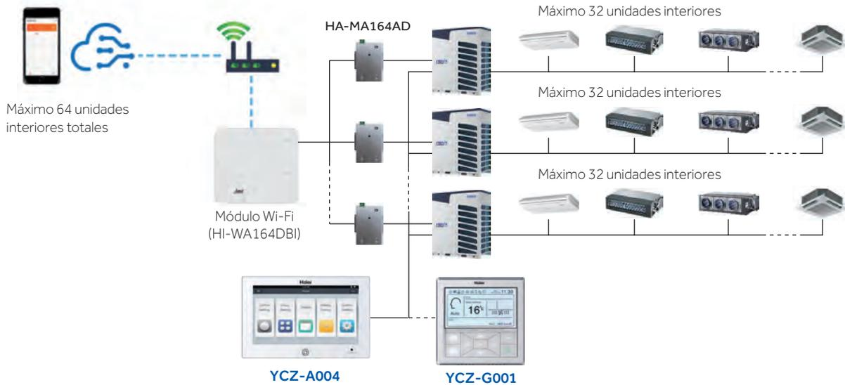
Acoplado a una red BMS o a un sistema local, siempre con la incorporación de adaptadores HA-MA
