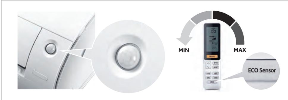
Con dos módulos incorporados, el sensor Eco utiliza una detección de doble área con un ángulo máximo de 120 grados y una distancia de 8 m. El sensor detecta automáticamente la presencia de personas dentro de una habitación y ajusta el flujo de aire activando el modo «Seguir» o «Evitar» de acuerdo con sus necesidades específicas.
