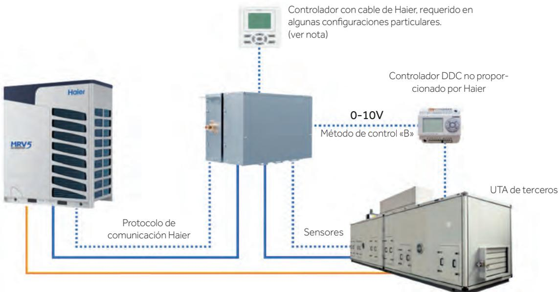
Tuberías de refrigerante líquido/gas, solo la tubería de líquido entra en la caja de válvulas y luego continúa a la batería de expansión directa. La tubería de gas va directamente de la unidad exterior a la batería dentro del UTA.
