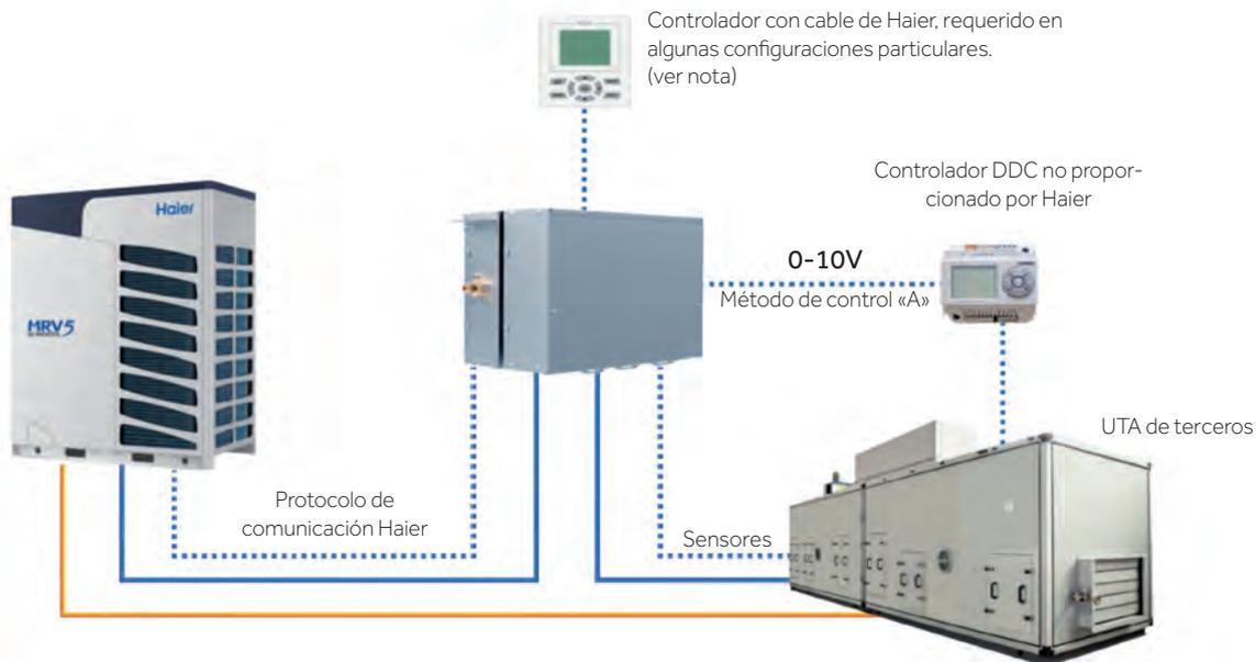
Tuberías de refrigerante líquido/gas, solo la tubería de líquido entra en la caja de válvulas y luego continúa a la batería de expansión directa. La tubería de gas va directamente de la unidad exterior a la batería dentro de la UTA.
