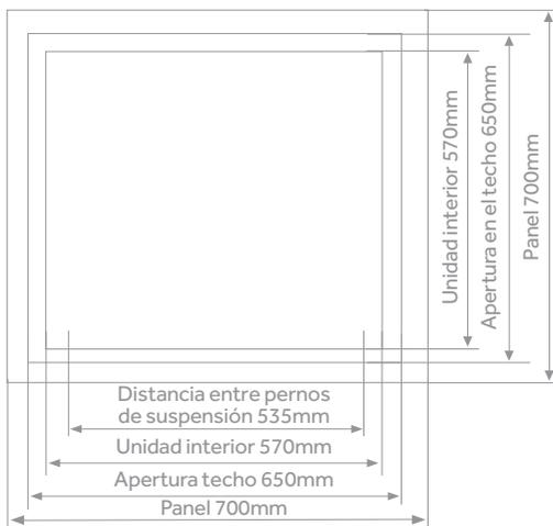
El solapamiento entre el techo y el panel debe ser de 25mm
