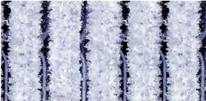
La capa de escarcha que se forma en el evaporador/condensador genera una fuerte fuerza de expansión en frío que elimina fácilmente la suciedad de la superficie.
