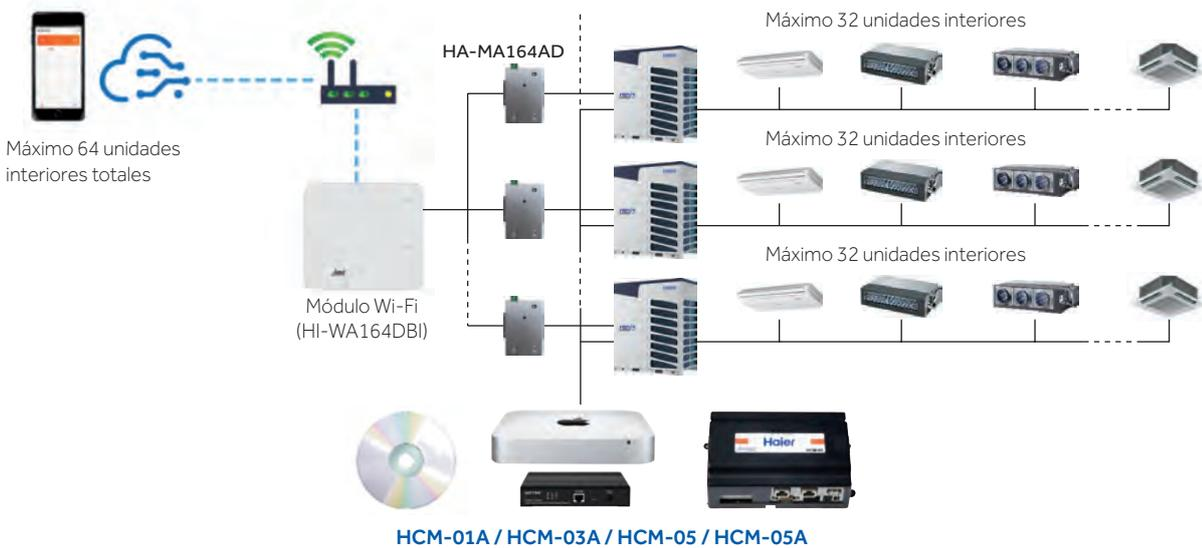
Si se requiere un control centralizado y las unidades externas **NO** son la serie 5, sino la serie 3Cplus o S (descarga frontal), debe agregar 2 interfaces HA-MA para cada unidad exterior, 1 para wi-fi y 1 para el mando centralizado
