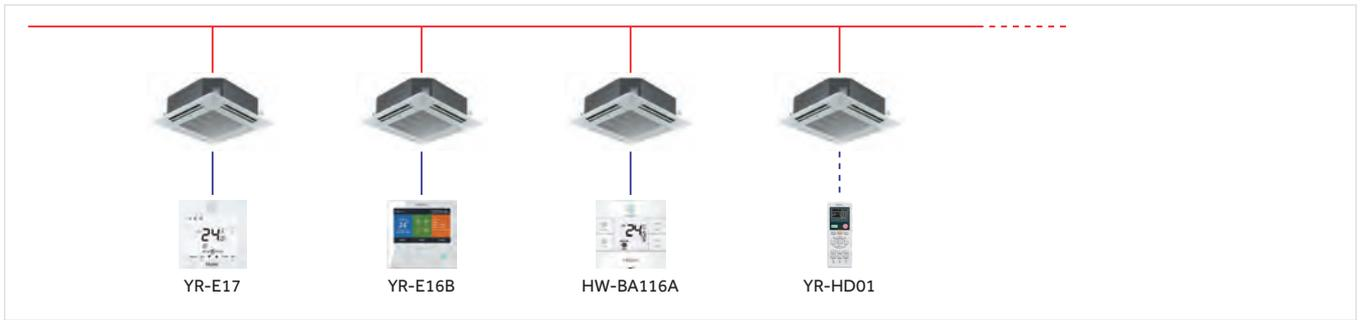
**Ejemplo de controlador de grupo (solo para controladores con cable - máximo 16 unidades interiores en un solo control)**
