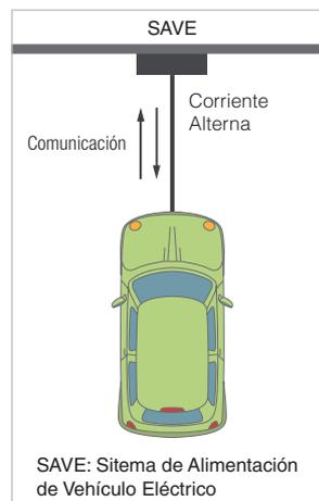
**Modo de carga 3:** Recarga directa con SAVE. Dispositivos de control en el propio SAVE.
